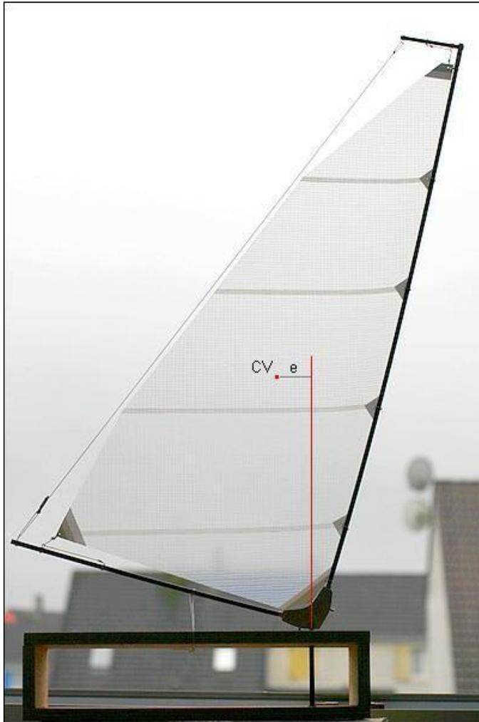
N.B.1 Dans un courant d'air de vitesse peu élevée, la chute a conservé sa tenue malgré le manque de lattes. L'effet dièdre peu marqué et la superposition mylar + adhésif + mylar semble avoir assuré cette tenue mais je doute un peu qu'il en soit ainsi avec un vent plus fort.
