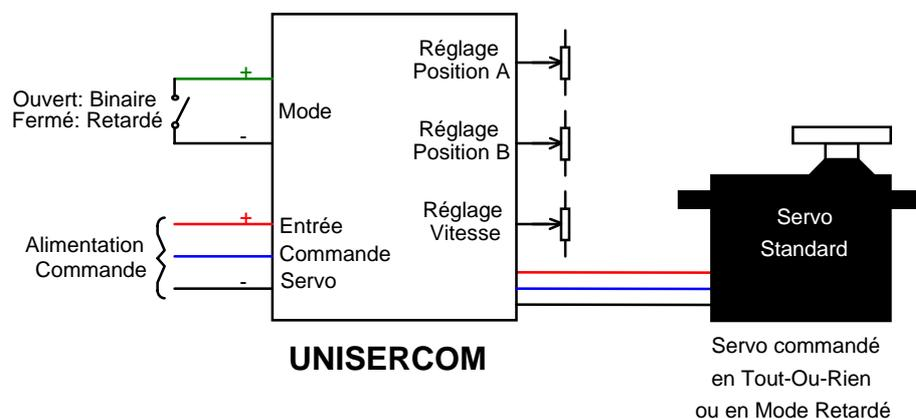
Le montage **UNISERCOM** basé sur un microcontrôleur **PIC 12F675** de chez [Microchip](http://www.microchip.com) permet de fixer les limites des positions extrêmes d'un servo standard ainsi que la vitesse de déplacement du palonnier entre ces 2 positions.
